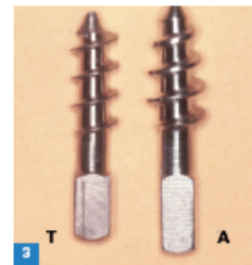
Fig. 3 A sinistra una vite in titanio (T), a destra la corrispettiva in cromo cobalto (A). Fig. 4 Una serie completa di viti di Tramonte con diametro di 5 mm da 2 a 7 spire.
